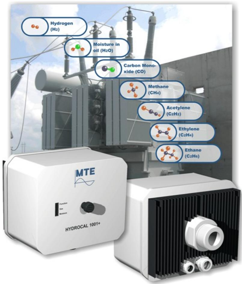
Прибор HYDROCAL 1001 это стационарно устанавливаемый анализатор смеси газов, растворенных в трансформаторном масле, предназначенный для анализа следующих ключевых газов (ВПКГ = Взвешенная Полная Концентрация горючих Газов):
