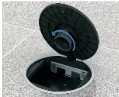
Деблокировка тубуса Открыть крышку, разблокировать тубус, повернув его налево, и переместить вверх.
