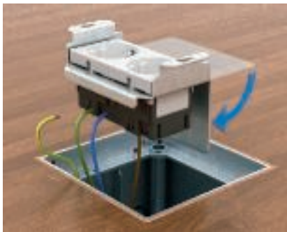
Монтаж розетки на рамке Установить розетку в металлическую рамку, зафиксировать и подключить. После подключения провода РЕ повернуть металлическую рамку на 90°.
