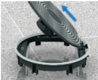
Демонтаж откидной крышки Поднять крышку примерно на 45° и потянуть с одной стороны вперед.
