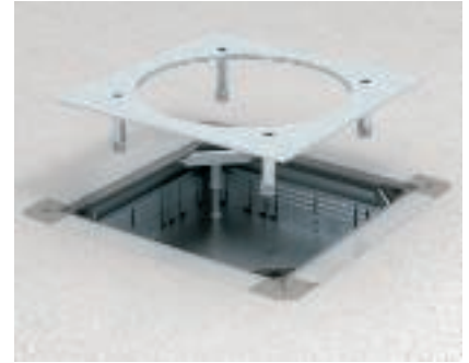
Подготовка системы прокладки кабеля под полом Усиленную крышку установить на монтажном основании. Отрегулировать опоры по высоте и закрепить контргайками.
