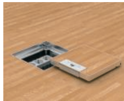
Облицовка крышки фрагментом напольного покрытия Очистить крышку от загрязнений и вставить в нее фрагмент напольного покрытия. Приклеить напольное покрытие.
