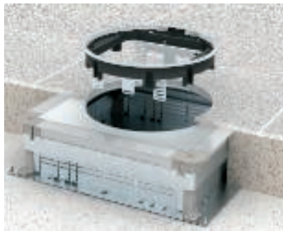
Монтаж лючка GRAFT9 в системах кабельных каналов Лючок установить сверху в отверстие в монтажной крышке и прикрепить с помощью винтов. Крепежный элемент заходит под монтажную крышку.
