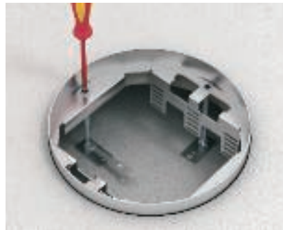
Регулирование высоты кассетной рамки Установить кассетную рамку на верхнюю кромку напольного покрытия. Отрегулированную высоту нивелировочных винтов зафиксировать с помощью контргайки.
