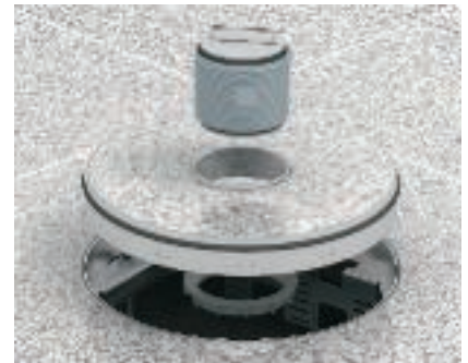
Монтаж тубуса Установить тубус в монтажное отверстие и закрепить контргайкой. Рамка для стыковки с напольным покрытием должна располагаться вровень с поверхностью напольного покрытия.
