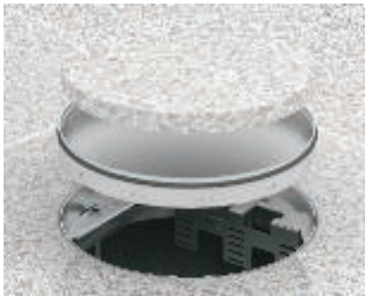
Укладка фрагмента напольного покрытия в кассетной рамке RKR Вложить фрагмент напольного покрытия в выемку в кассетной рамке и приклеить. Оставшийся зазор между напольным покрытием и кассетной рамкой уплотнить с помощью соответствующего материала.
