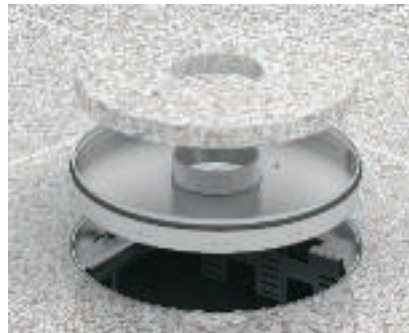
Укладка фрагмента напольного покрытия в кассетной рамке RKFR Вложить фрагмент напольного покрытия в выемку в кассетной рамке и приклеить. Оставшийся зазор между напольным покрытием и кассетной рамкой уплотнить с помощью соответствующего материала.
