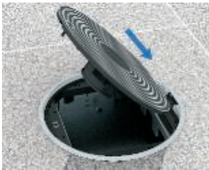
Монтаж откидной крышки Крышку с углом раствора 45° установить перед шарнирным креплением и надавить назад.
