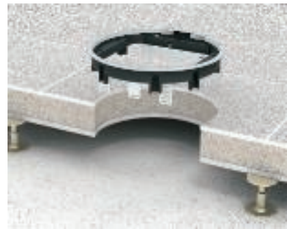
Монтаж лючка GRAFT9 в двойном и фальшполу При установке в двойных и фальшполах универсальный крепежный уголок действует как распорная лапка. Затянуть винт максимум на 4 оборота. Лапки фиксируют лючок в монтажном отверстии.
