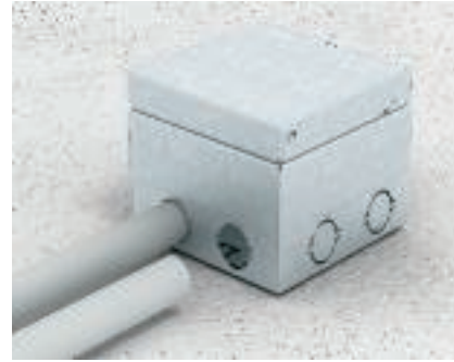
Подсоединение электромонтажных труб Подвести трубы М25, максимально допустимое погружение при этом составляет 5 мм.
