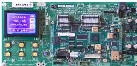
Информация относительно состояния стабилизатора напряжения может быть передана через связь Ethernet стандарта, GPRS модем или локально через USB накопитель.
