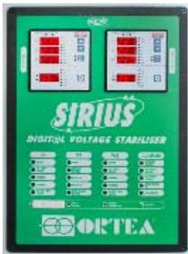
Панель контроля стабилизаторов напряжения, серии Sirius, в отличие от панели серии Orion Plus дополнена светодиодами контроля: перегрев ролика токосъемной каретки, наличие информации на дисплее платы сигнализации и мониторинга.
