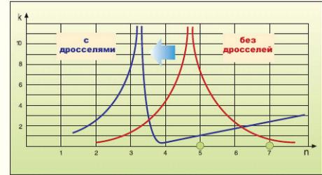
Сдвиг резонансной частоты ниже 5й гармоники
