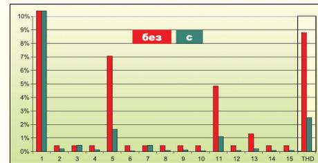
Пример фильтрации гармоник напряжения
